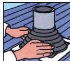
3. Dektite® formgenau an Profilblech anpassen
