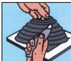
1. Dektite® an Rohr anpassen
