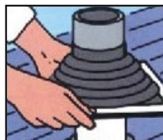
2. Dektite® an Profilblech anpassen und markieren
